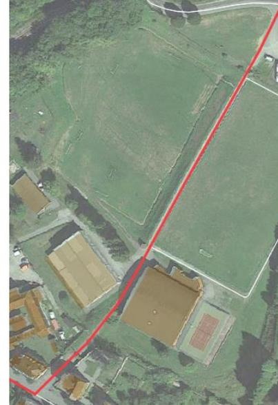
**Tronçon Route de Vallières – Avenue de la Gare** : Balisage et création d'une voie dédiée. Retirer les portails aux entrées du cheminement central entre les deux stades. Remplacer par des dispositifs anti-intrusion des véhicules. Élargissement du chemin à 2m à côté du gymnase. Requalification de la traversée en voie verte.
