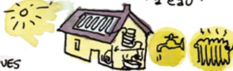
LES RAYONS CHAUFFENT UN FLUIDE CALOPORTEUR, ACHEMINÉ VERS LE CHAUFFE-EAU ET/OU LA CHAUDIÈRE.
