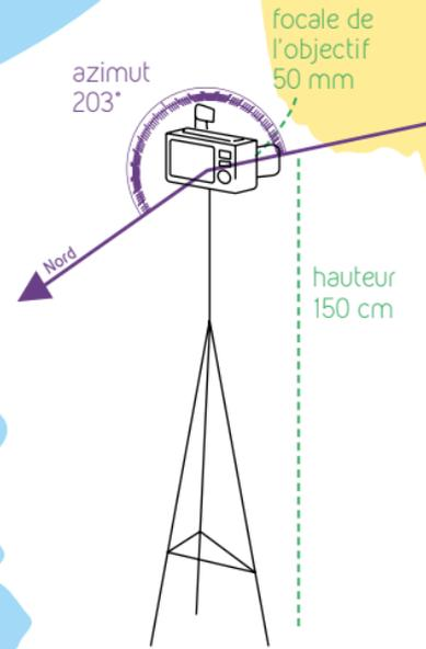
Exceptionnellement, il peut être utile de régler l'inclinaison de l'appareil.
